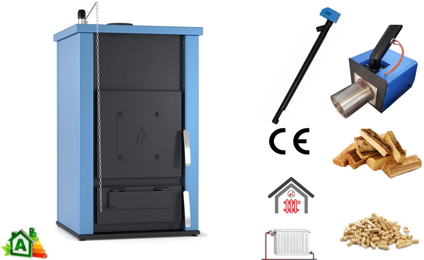
CALDAIA POLY 31 kw è una caldaia a legna che può riscaldare il nostro spazio attraverso il circuito del radiatore. Con perimetro isolante 25 mm di lana di roccia e oltre 25 mm di lana di ceramica. Può essere convertito in una caldaia a pellet posizionando un bruciatore. È collegato alla valvola idrostatica (non in dotazione). Nella parte inferiore, c'è un cassetto in cui è raccolta la cenere, rendendo più facile la sua rimozione.
